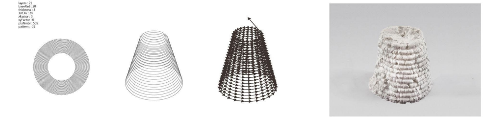
Fig. 3. Rampe d’extrusion. Trajectoire paramétrique dessinée sur Rhino-grasshopper et photographie de l’objet de porcelaine produit. La distance de captation ne varie pas significativement, l’extrusion s’achève lorsque le robot se retire de la zone de déposition.
